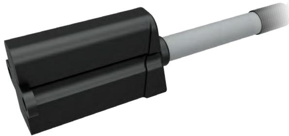
Unser Hallsensor kann als kostengünstige Lösung eingesetzt werden, wenn die Anforderungen an die Positioniergenauigkeit nicht sehr hoch sind. Die Wiederholgenauigkeit liegt im Bereich von 30 µm, während sich die absolute Genauigkeit im Bereich von 100 µm bewegt. Dank der Integration beider Sensoren wird der analoge Sensor für die exakte Positionierung und der digitale Sensor für die Kommutierung verwendet. Die Kombination beider Sensoren bietet dem Kunden eine „Free Wake & Shake“-Bedienung.
